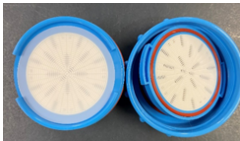
プラスティクスホルダーに混合セルロースエステルタイプ陰電化膜を装着
