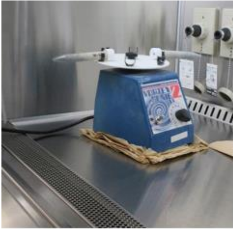
15ml PowerBead Tubeをアダプターにつけてボルテックスしているところ
