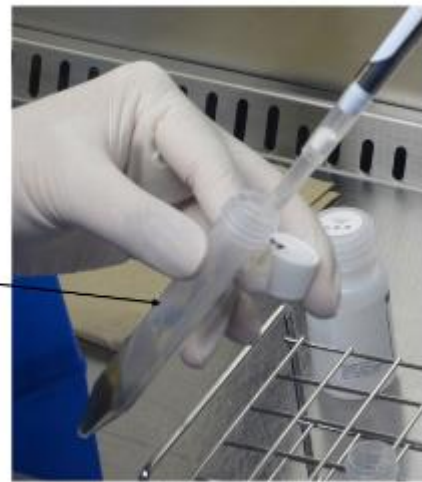
1mlロングチップを使って水層を移す。 中間層を吸い込まないように注意する。
