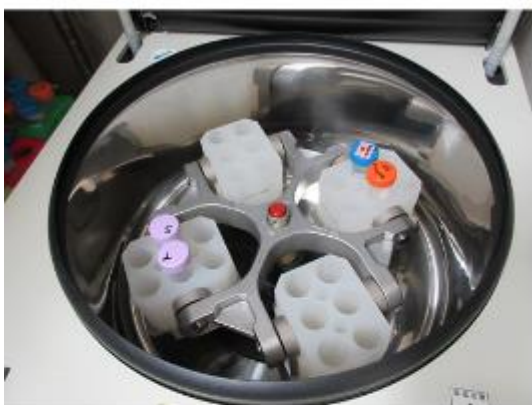
スイングローターで遠心 (アングルローターでは底にたまらない)
